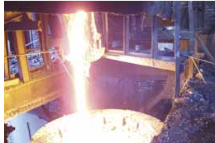
Рудотермические электропечи РКО-25 мощностью в 25 мегаватт
